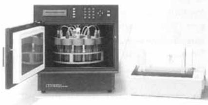
ca. 40 Soxhlet-Extraktionen notwendig wäre, über 500 Versuche im MES 1000 gefahren werden können. Die Verwendung von Druckgefäßern ermöglicht nicht nur eine deutliche Verminderung des Lösungsmittelverbrauchs, sondern auch höhere Extraktionstemperaturen und somit bessere Extraktionen in kürzerer Zeit. Mit dem MES 1000 lassen sich bis zu 12 Extraktionen gleichzeitig durchführen.
