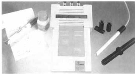
Für die Wasseranalytik bietet Lange diverse Laborphotometer an. Bei den Multi-Dioden-Array-Photometern des Typs „ISiS 6000“ und „ISiS 9000“ wird das Licht durch ein feststehendes Gitter zerlegt und gleichzeitig vom Multi-Dioden-Array erfaßt. Gleichzeitig werden Trübungen und Eigenfärbungen in der Probe erkannt, und die daraus resultierenden Fehler werden korrigiert. Die Geräte sind mit E-PROM CARDs ausgerüstet. Das Spektralphotometer CADAS 50s wertet mit dem Barcodelesesystem IBR die Küvetten-
